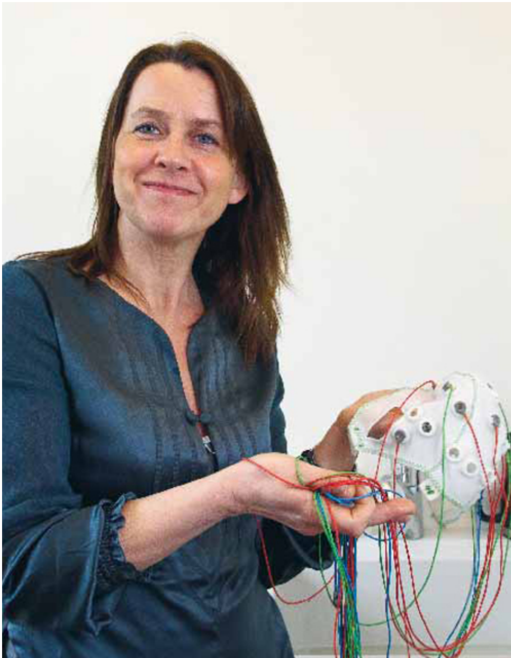
AVANSERT UTSTYR: Hetten med sensorer settes på forsøkspersonens hode for måling av hjernens aktivitet.
